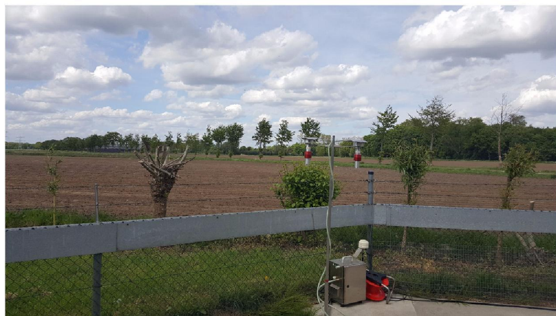
Fig 3. Meetopstelling vierdaagse metingen op het erf, Derenda 10 L/min met Harvard impactor (PM 10 ).
